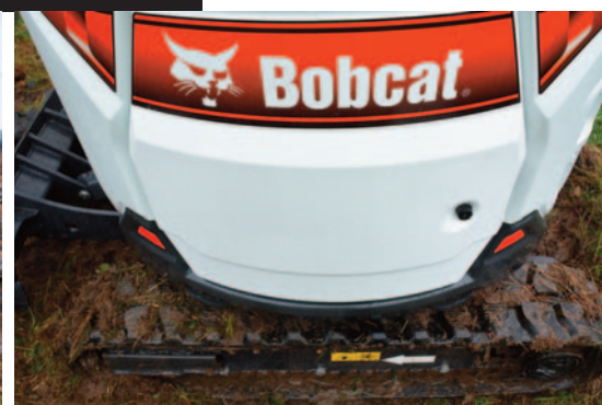
Carro e lama allargabili da 980 a 1.360 mm
