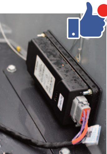
CONNESSO DI SERIE A sinistra, il trasmettitore dati IP67 montato alle spalle del sedile operatore. Qui sopra il manuale operatore in versione smart e impermeabile, anch'esso riposto in un vano dedicato dietro al sedile.
