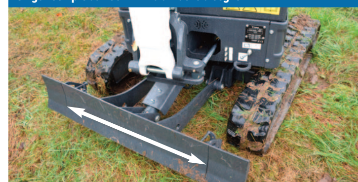
Carro e lama allargabili da 980 a 1.360 mm
